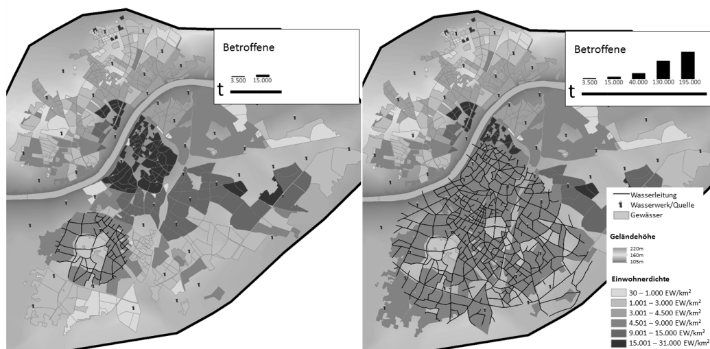
Abb. 3: Simulationsergebnis der Ausbreitung der Folgen eines Ausfalls der Wasserversorgung
