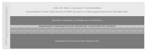
**Abb. 5:** Aufbau eines Clearmode-Codecs
