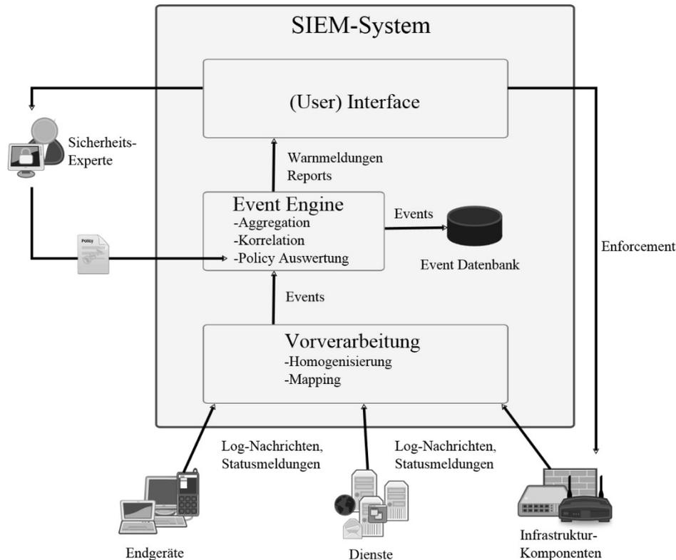
Abb. 1: SIEM-Systemaufbau und Kommunikationsschnittstellen
