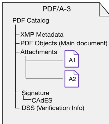
Abb. 3: Struktur eines signierten PDF/A-3 Dokuments mit 2 Dateianhängen
