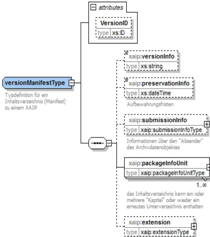
**Abb. 1:** Aufbau eines Elements vom Typ `versionManifestType`
