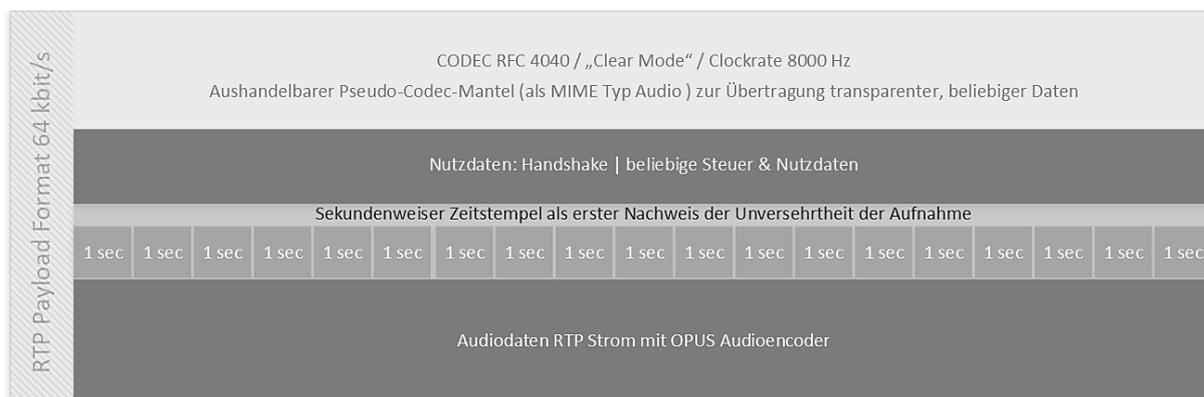
**Abb. 5:** Aufbau eines Clearmode-Codecs
