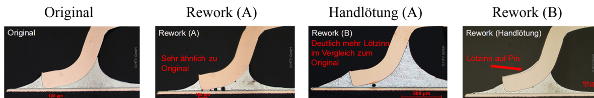
Abb. 9: Schliffbild durch die Lötstellen der SOP-Bauteile.
