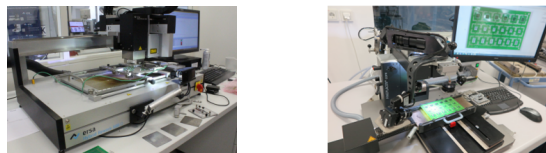
Abb. 2: Verwendete Reworksysteme Links: Ersa (HR 600/2), Rechts: Finetech (Fineplacer Core)
