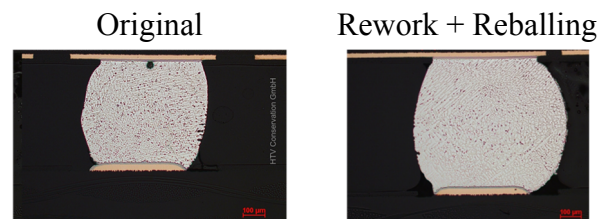
Abb. 10: BGA-Balls im Schliffbild. Links: Original. Rechts: BGA-Balls nach einem Reballing.
