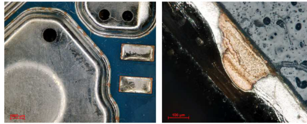
Abb. 22: Links: Schutzblech Rechts vergrößerte Verfärbung auf dem Rand des Blechs.
